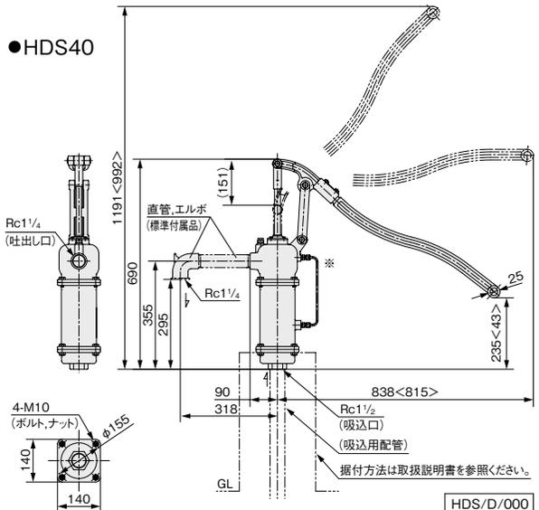
① ポンプから水面までの距離は、吸込揚程以内(配管損失含む)でご使用ください。
