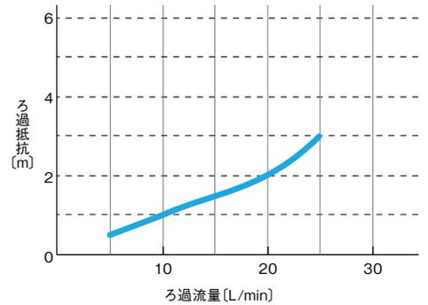
② 原水水质(鉄・マンガン・全硬度)によりろ過流量を設定、最大ろ過流量又は設定ろ過流量を超えると正常にろ過できなくなります。ポンプは、上記のろ過抵抗を考慮し選定してください。
