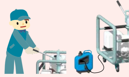
手押しポンプで給水 オプションの発電機で給水
