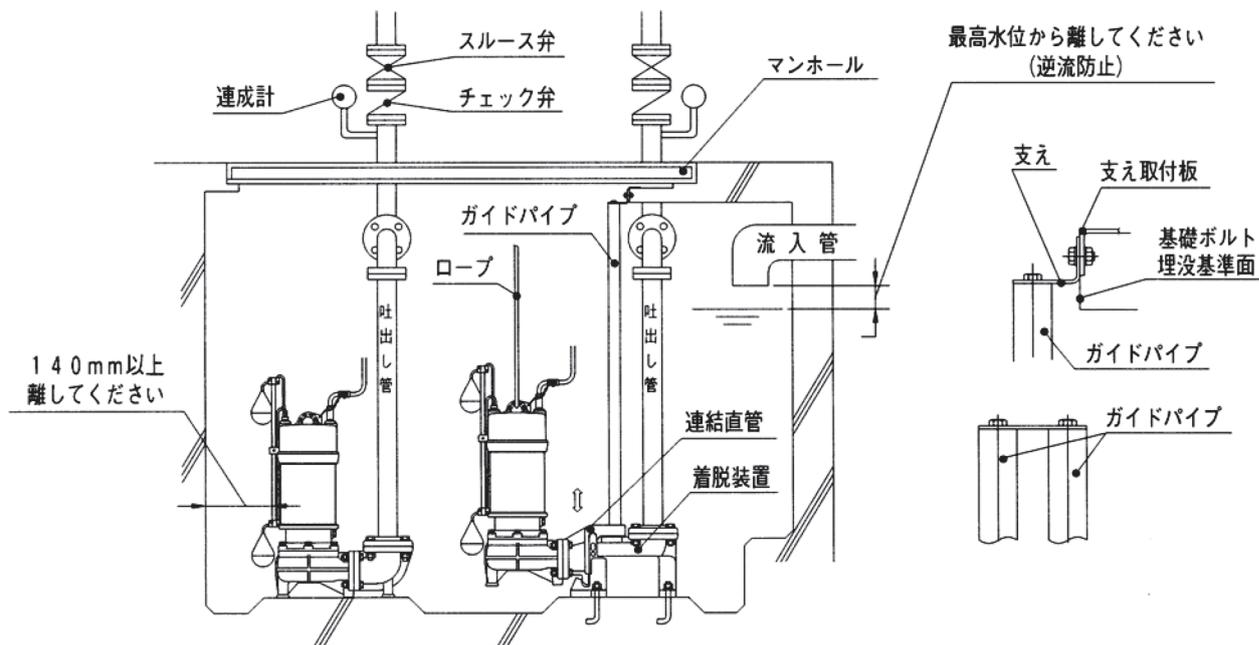
(注) 着脱タイプにてご使用の際はスルース弁、チェック弁は槽外に設置してください。
