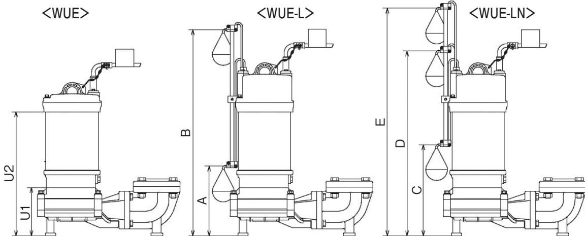
U1：運転可能最低水位（この水位以下で運転しないでください、揚水不能、振動等が発生します。）
