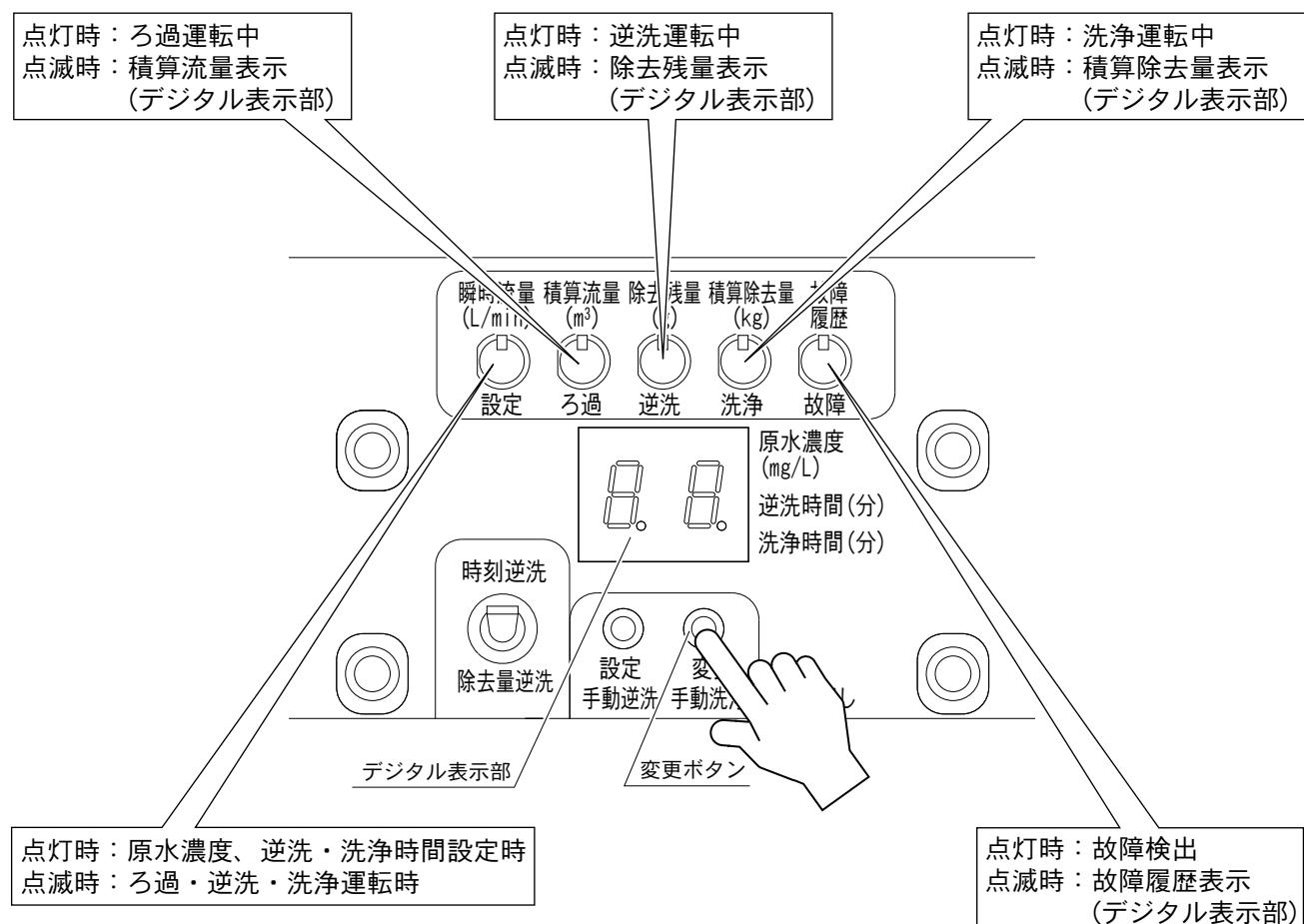
\*逆洗・洗浄運転中に「変更ボタン」を押すと、残りの運転時間が表示されます。
