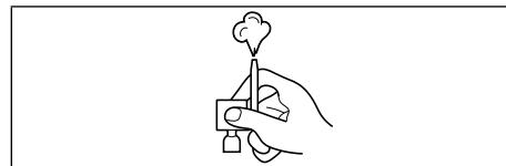
4 ノズルの先端を検液の中に入れ、指をゆるめて検液を試薬室に吸入します。
