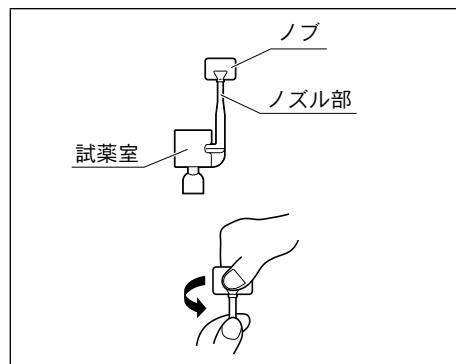
3 試薬室を指で押して、容器内の空気を追い出します。
