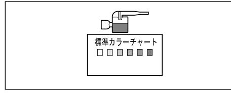
6 残留塩素濃度が「水処理機器選定書」に記載の値より低い場合は、除菌器の注入比率を変更して、残留塩素濃度を調整します。
