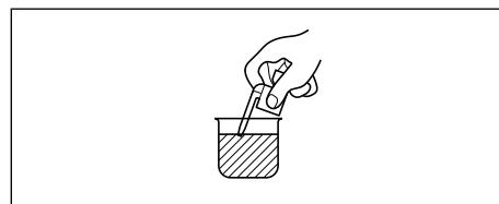
5 ノズル部を持ちよく振って混ぜ、約20秒後に標準カラーチャートの色と比較して、残留塩素濃度を判定します。
