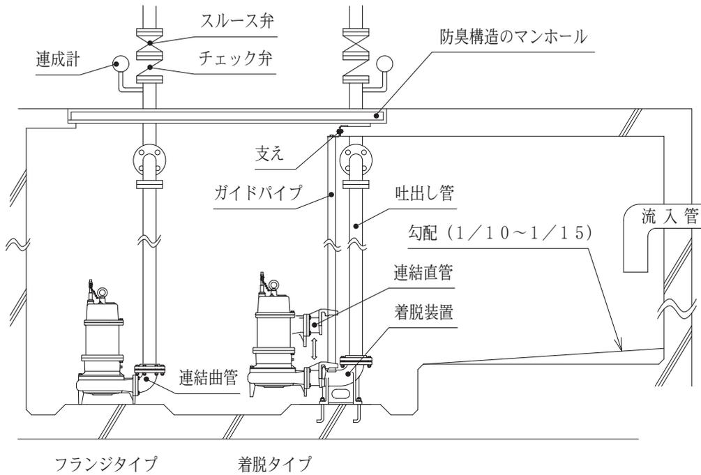
7. 着脱装置にポンプをセットする場合
