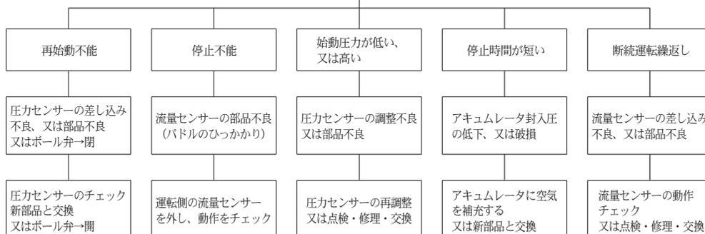
※1. 流量センサーはコネクタから外すとポンプが停止するように設計されています。
