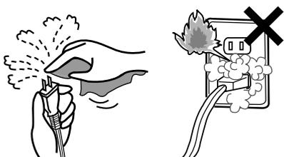
**!** 電源投入前に配線接続部・結線部が緩んだり外れたりしていないか、確認してください。一箇所でも緩んだり外れたりしていると、火災・感電の原因になります。
